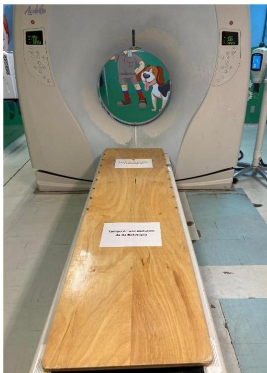
Figura 1. Tomógrafo adaptado com a prancha de madeira para o planejamento radioterápico.
