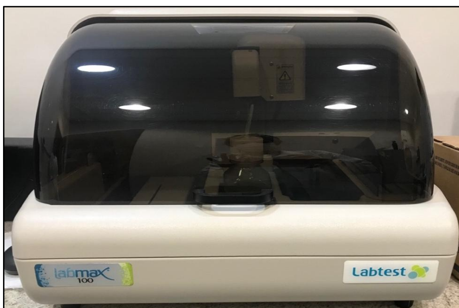
Figura 2. Máquina semi-automatizada LabMax100 da marca Labtest® utilizada para realização de exames bioquímicos. Fonte: Arquivo pessoal (2020).
