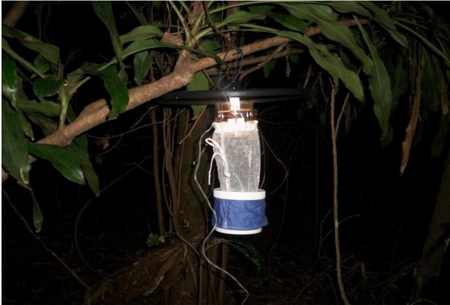
Figura 1. Armadilha luminosa do tipo “CDC” (Center on Disease Control).
