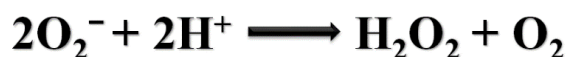
Figura 3. Formação do peróxido de hidrogênio ( H_2O_2 ) a partir da reação entre dois íons superóxido ( O_2^- ) e dois prótons de hidrogênio ( H^+ ).
